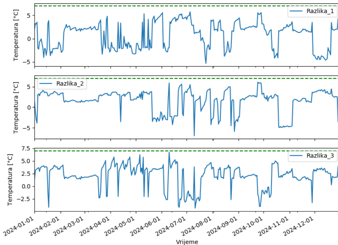
Grafički prikaz 5-4: Razlika temperatura na ulazu i izlazu sustava za uplinjavanje UPP-a, na sve tri jedinice. Zelena crtkana linija predstavlja 7 °C.
