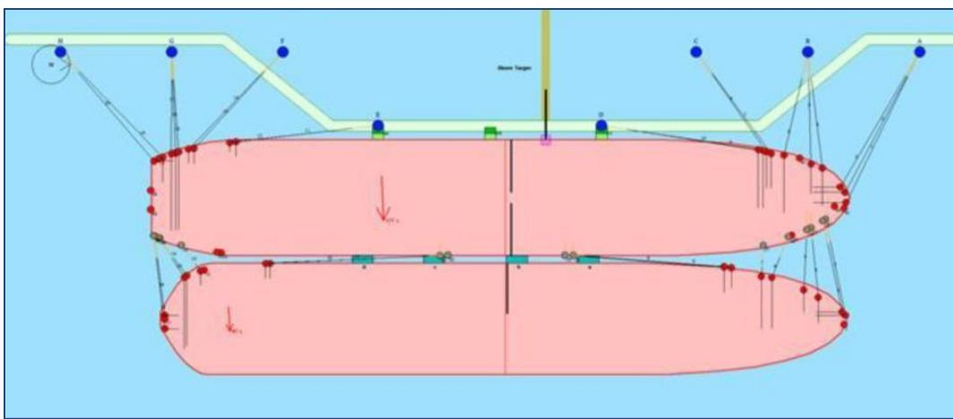
Slika 62 Shematski prikaz priveza LNG broda na FSRU brod
