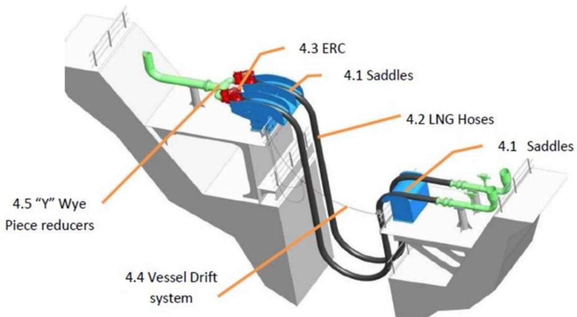
Slika 27 Izolacijski komplet između LNG i FSRU broda
