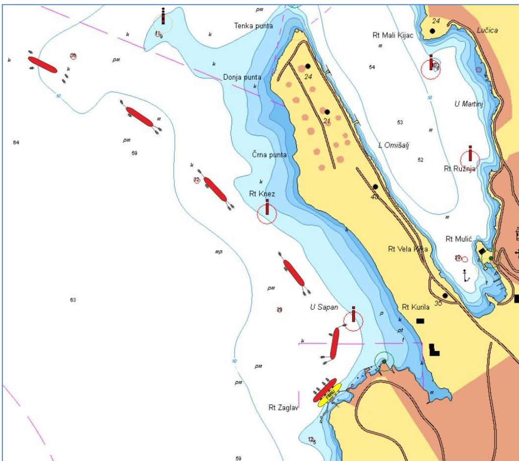
Slika 50 Načelni način pristajanja broda lijevim bokom
