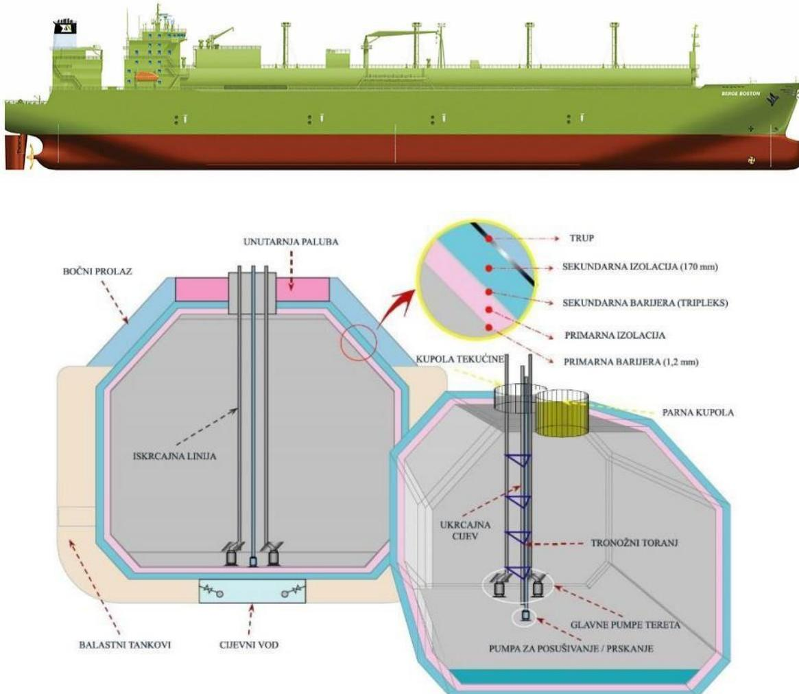
Slika 16 LNG brod s membranskim tankovima tipa Technigaz Mark III
