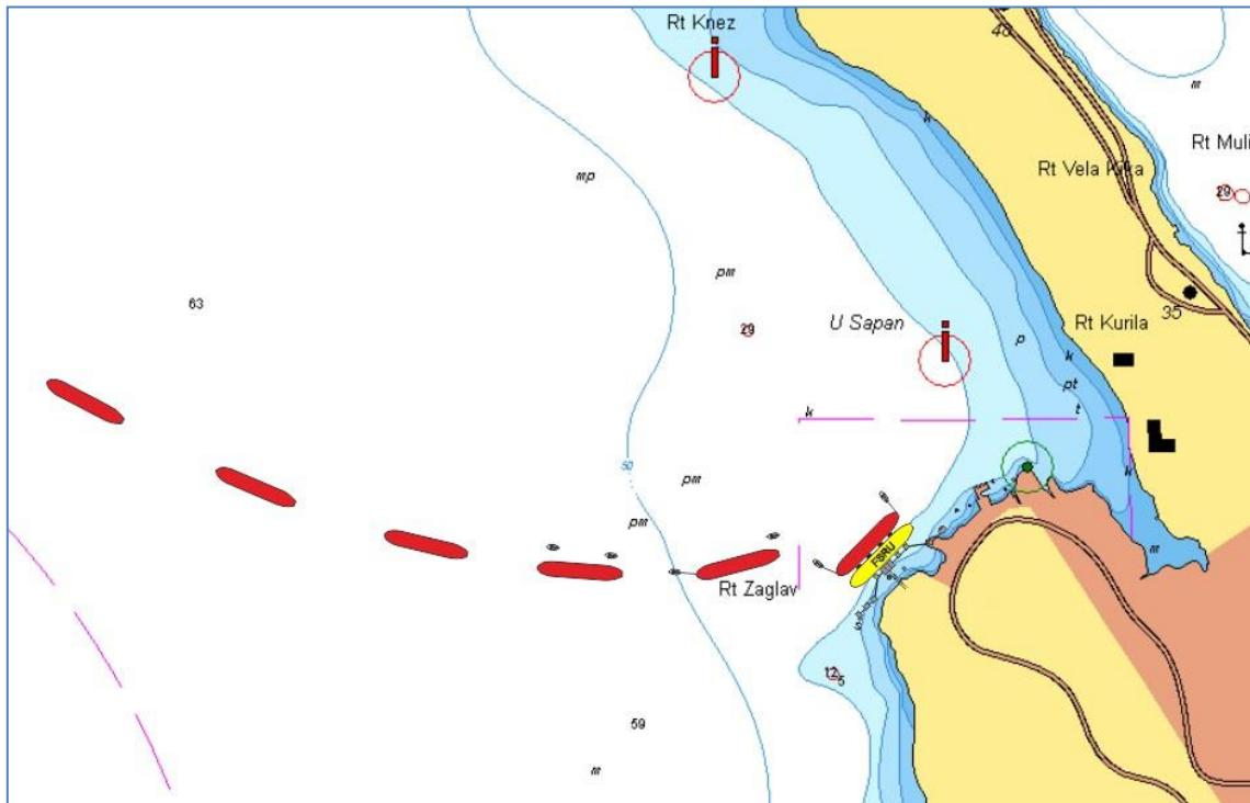
Slika 53 Manevar isplovlijenja broda privezanog lijevim bokom
