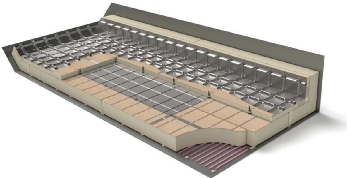
Slika 17 Presjek tanka GTT Mark V membranskog sustava
