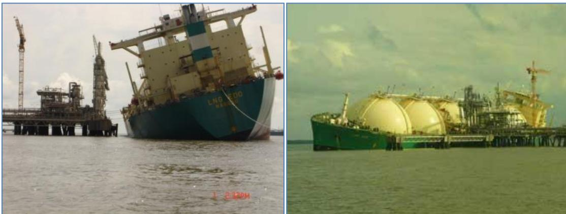
Slika 75 Nagnuće broda *LNG EDO* uslijed nepravilnog balastiranja broda
