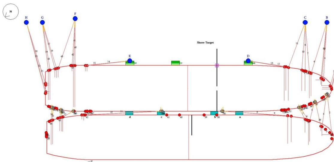
Slika 71 Privez LNG QMax broda na FSRU QMax brod
