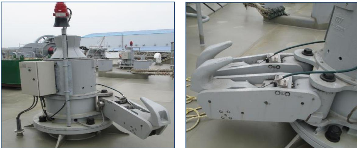
Slika 66 Brzo otpuštajuće kuke na FSRU brodu (jednostrukе i dvostrukе)
