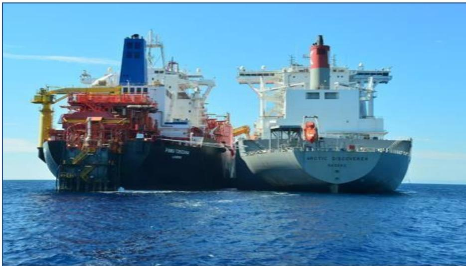
Slika 29 Prekrcaj korištenjem prekrcajnih ruku u nezaštićenom području
