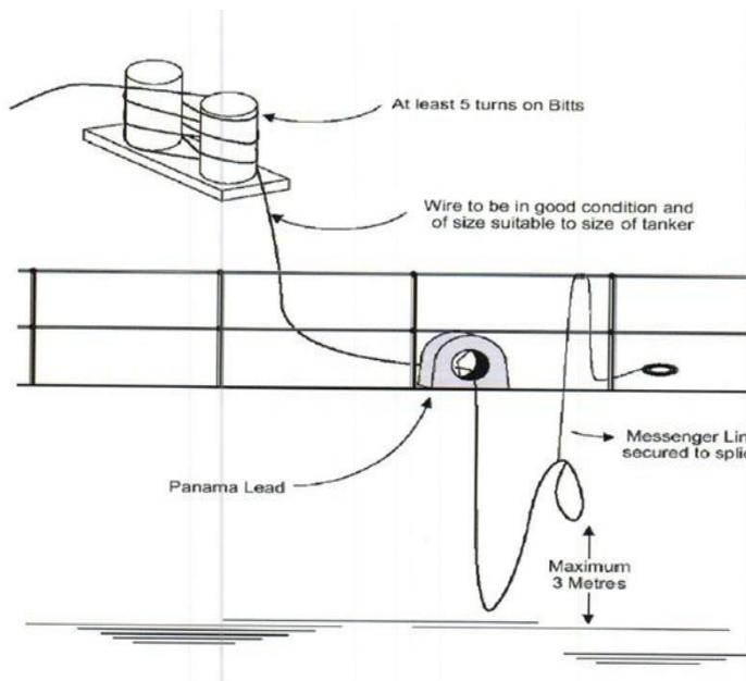
Slika 73 Pozicioniranje čeličnog užeta za tegljenje u nuždi
