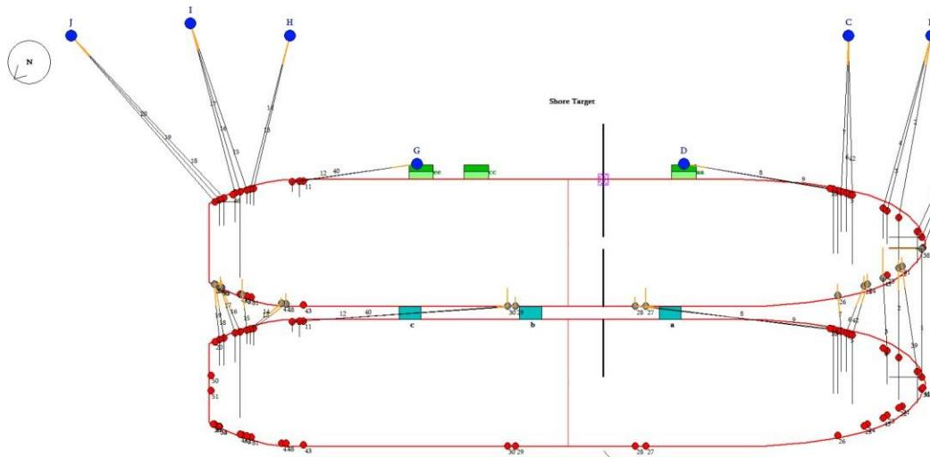
Slika 70 Privez LNG broda na FSRU brod (oba 170.000 m<sup>3</sup>)<sup>56</sup>
