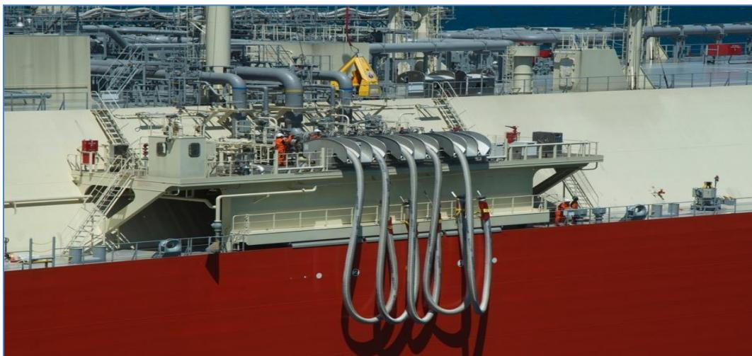
Slika 24 Fleksibilne prekrcajne cijevi na FSRU brodu
