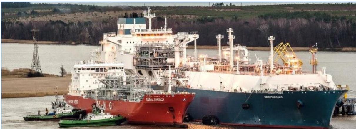
Slika 10 Privez LNG bunker broda na LNG FSRU brod
