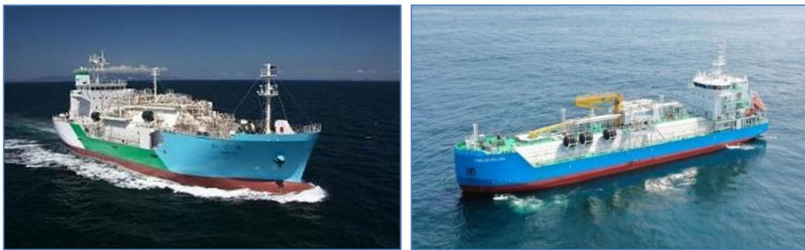
Slika 1 LNG brodovi za opskrbu gorivom kapaciteta kapaciteta 3.500 m<sup>3</sup>
