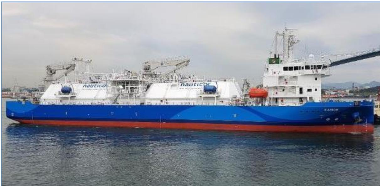
Slika 9 Odbojnici te dizalice na LNG bunker brodu
