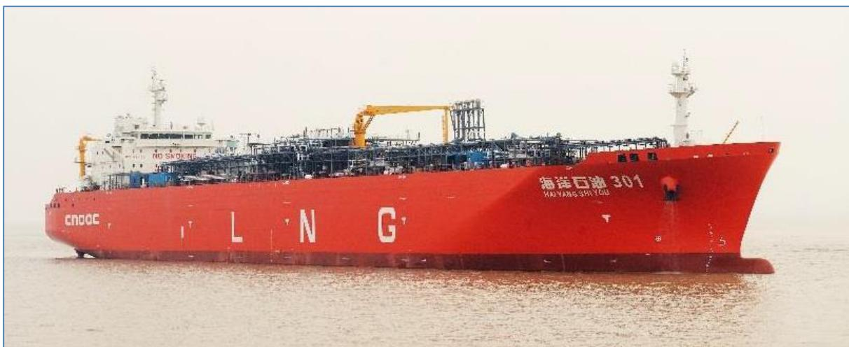
Slika 17 LNG brod za razvoz kapaciteta 30.000 m<sup>3</sup>
