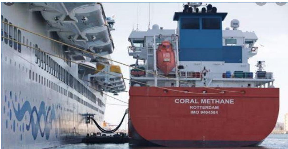
Slika 8 Opskrba gorivom broda za kružna putovanja sa LNG bunker broda kapaciteta 7.500 m<sup>3</sup>
