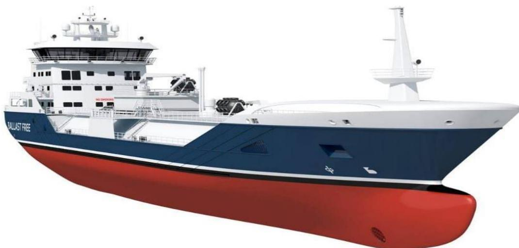
Slika 12 Ilustracija "Ballast free" LNG broda kapaciteta 7.500 m<sup>3</sup>
